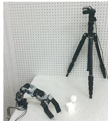
図 2：三脚に固定したカメラでスポンジの位置・姿勢を認識し, マニピュレータのハンドで把持するイメージ
